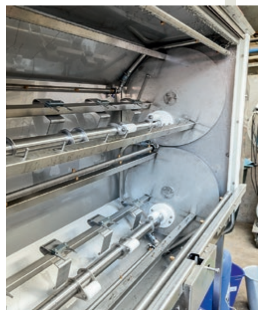
Unabhängig vom Fabrikat der Eimer finden in der aktuellen Ausführung der Grete bis zu zehn Eimer gleichzeitig Platz. Zum Trocknen können die Eimer im Automaten verbleiben.
