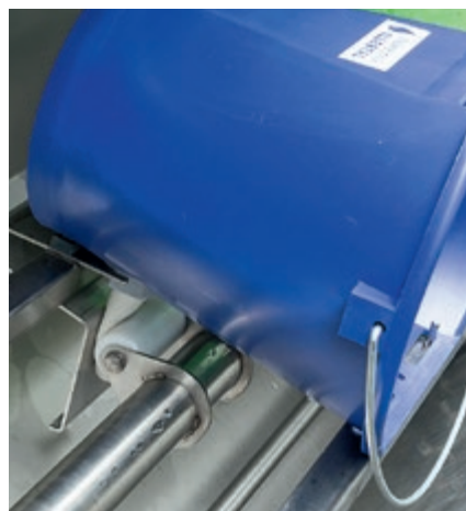
Die Apparatur streicht jeden Nuckel pro Reinigungsvorgang 100 Mal aus. Die Halterung zum Fixieren der Eimer passt universell zu jedem Eimerfabrikat.
